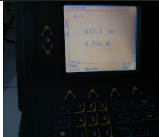
**Alat Spektrofotometer UV-Visibel (UV- Shimadzu)**
